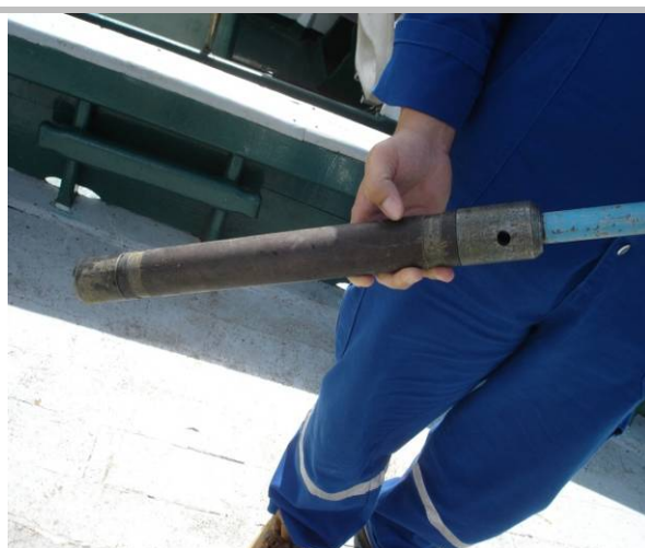
FOTO 6.3.7.7-2: Amostrador de sedimento tipo jet-probe , utilizado para as amostras em perfil
