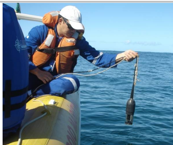
FOTO 6.3.7.6-3: Procedimento de leitura de parâmetros in situ, por meio de sonda multiparâmetro. Fonte: CRA, 2010b.
