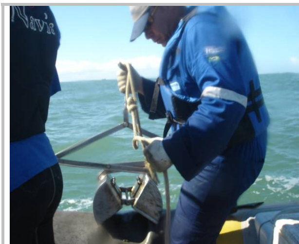
FOTO 6.3.7.7-1: Amostragem de sedimento por meio de draga tipo Petersen - sedimento superficial
