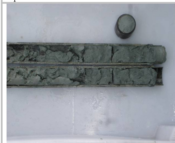
FOTO 6.3.7.7-1: Amostragem de sedimento por meio de draga tipo Petersen - sedimento superficial
