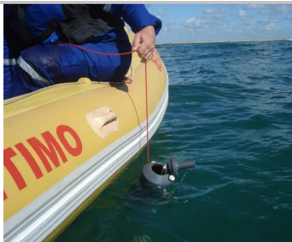
FOTO 6.3.7.6-2: Procedimento de amostragem de água, por meio de garrafa de Van Dorn: lançamento da garrafa. Fonte: CRA, 2010b.
