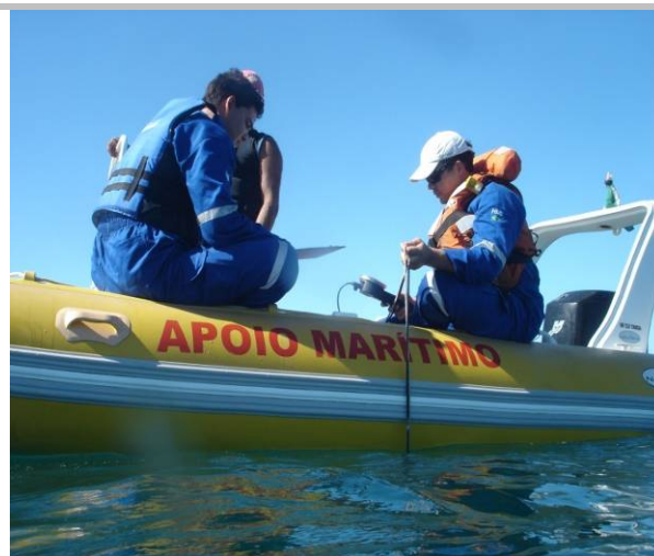
FOTO 6.3.7.6-4: Procedimento de leitura de parâmetros in situ, por meio de sonda multiparâmetro. Fonte: CRA, 2010b.
