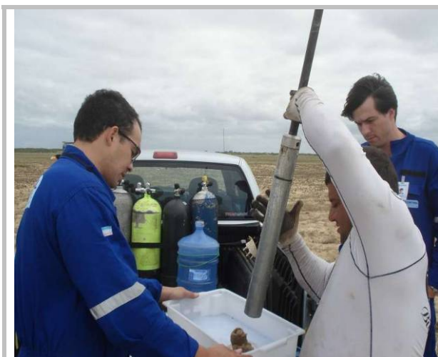
FOTO 6.3.7.7-5: Procedimento de amostragem – retirada da amostra de dentro do tubo de perfuração.
